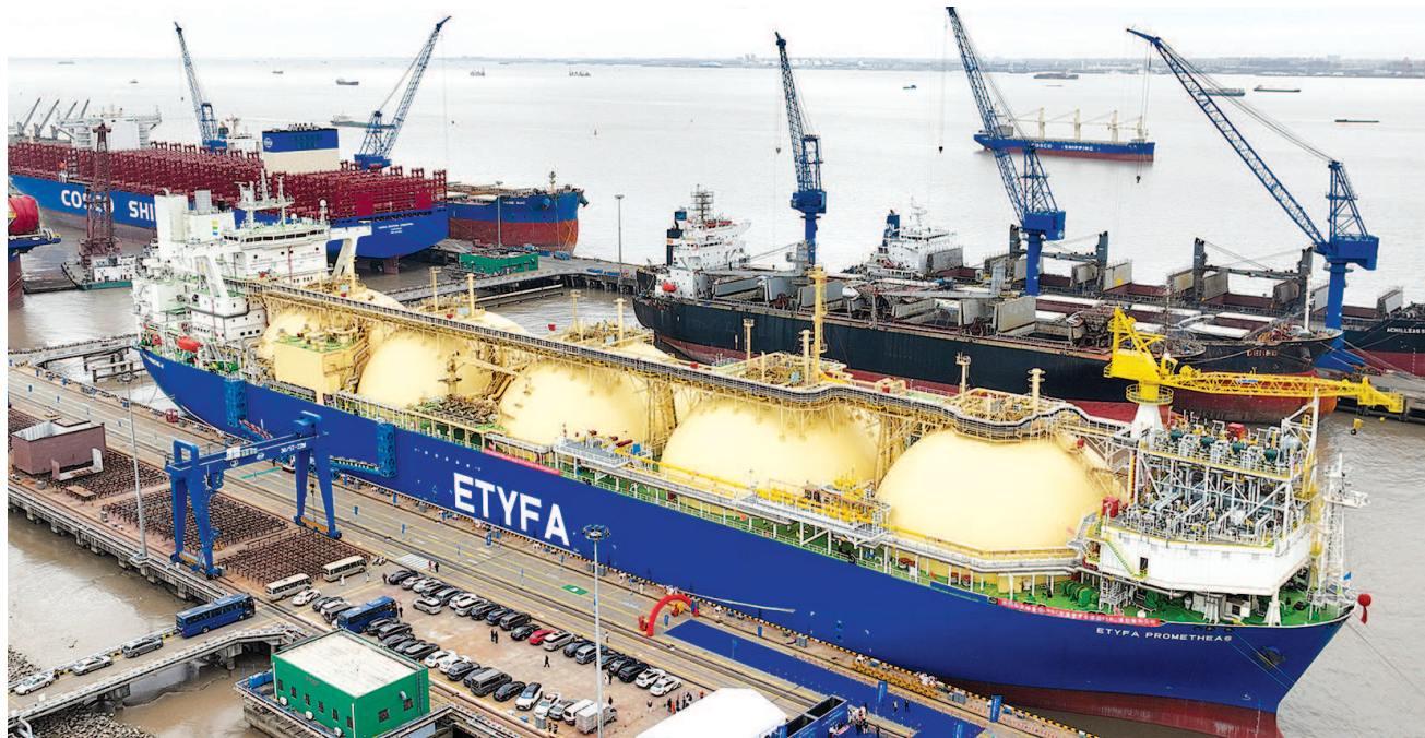
■ 格里亚FSRU改造完毕,停泊在码头上准备交付
